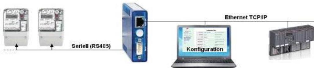
Das Modul **HITenergie2scada** wird einfach an die RS-485 Schnittstelle eines oder mehrerer Zähler angeschlossen und entsprechend die Auslesung über einen Browser mittels integriertem Webserver parametrierbar. In der Standardversion wird die Nutztabelle (T4, TS) des Zählers, die vom Kunden auch angepasst werden kann, verwendet und zyklisch ausgelesen. Die Daten werden dann auf Register gelegt die einfach per Protokoll MODBUS®-TCP, auch als Multizugriff, zur Verfügung gestellt.
